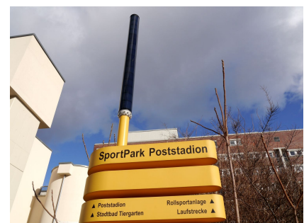
Mit Hilfe von Solarmodulen und LEDs an der Spitze leuchten die Stelen völlig autark im Dunkeln
