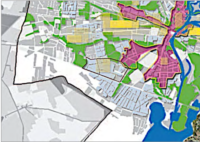
Analysekarte 07 - Gewässerqualität und Starkregen (im Gebiet: blau: Trennkanalisation, Schmutz- und Regenwasser; schwarze Kreuze: Siedlungsräume mit hohem Versiegelungsgrad)
