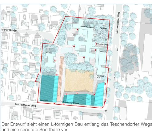
Der Entwurf sieht einen L-förmigen Bau entlang des Teschendorfer Wegs und eine separate Sporthalle vor.
