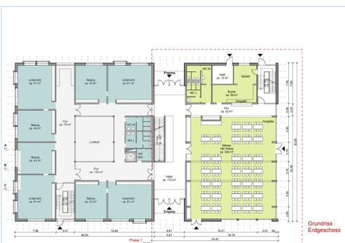
Im Erdgeschoss des im 1. BA geplanten Gebäudeteils (grün-unterlegt) findet sich die Mensa. Der zweite Gebäudeteil soll im 2. BA ergänzt werden.
