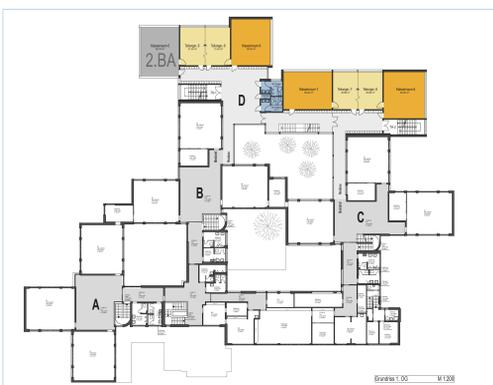
Der Grundriss der neuen Klassen- und Teilungsräume wiederholt sich auf allen 3 Geschossen. Farbiger unterlegte Gebäudeteile entstehen im 1. BA.
