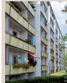
Die Wohnungsbauserie P 2 basiert auf einem Musterbau eines Wettbewerbes und sollte die Serien Q3, QX und QP ablösen. Das „P“ der Typenbezeichnung steht für „parallel“ zu den Fassadenflächen angeordneten tragenden Wänden, die „2“ für die Anordnung von zwei Aufgängen pro Gebäude.
