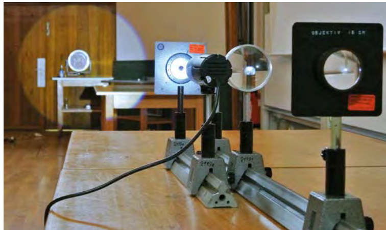
Versuchsaufbau mit der Toeplerschen Schlierenmethode an der Uni Freiburg. Aktuell kommt dieses Prinzip beim Sichtbarmachen von Corona-Viren in Aerosolen zur Anwendung.
