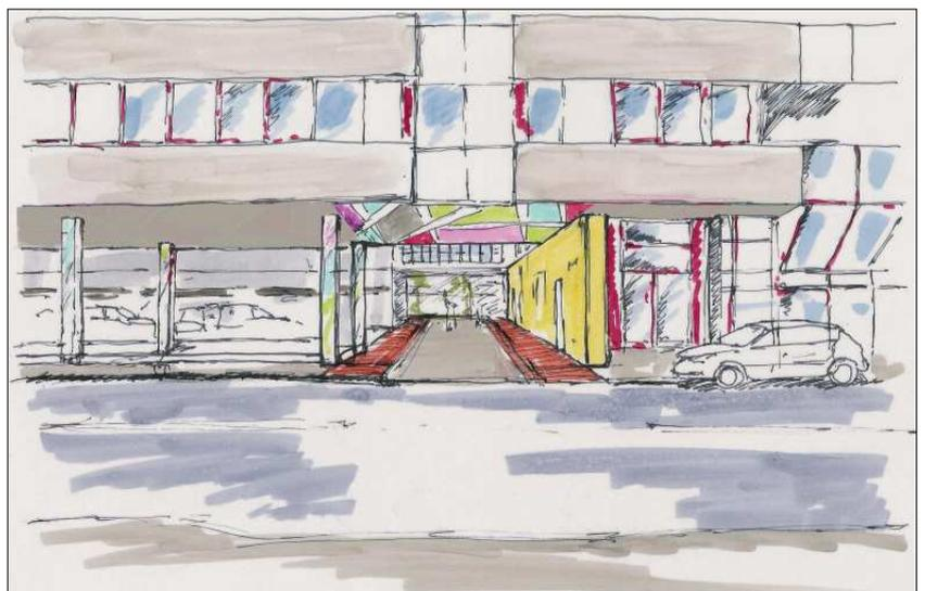
Die Skizze verdeutlicht die farbliche Betonung der seitlichen Fußwege und die möglichen Aufwertung des Durchfahrtsbereiches durch Wand- und Deckengestaltung.
